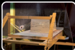
Disparo em Gelatina Balística através de parabrisa de automóvel (Vidro Laminado).
