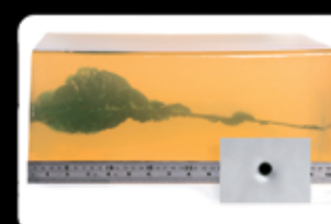
Resultado do disparo em Gelatina Balística através de duas Chapas de aço automotivo.
