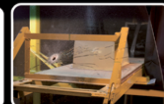
Disparo em Gelatina Balística através de parabrisa de automóvel (Vidro Laminado).
